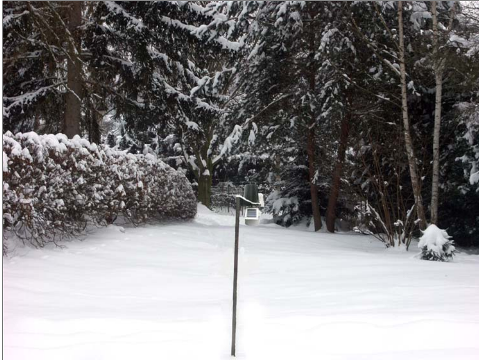
Wetterstation Bad Tabarz (419m üNN, Am Burgholz) DAVIS Vantage Pro 2 mit aktiver Belüftung und beheiztem Regensmesser Wetterstation über Rasenfläche in 2m Höhe, Windmesser in 10m Höhe
