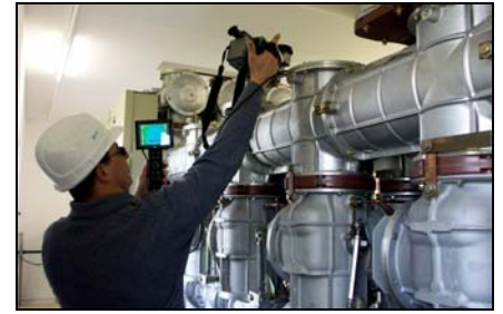
1 getrennter Aufbau von Monitor und IR- Kamera
