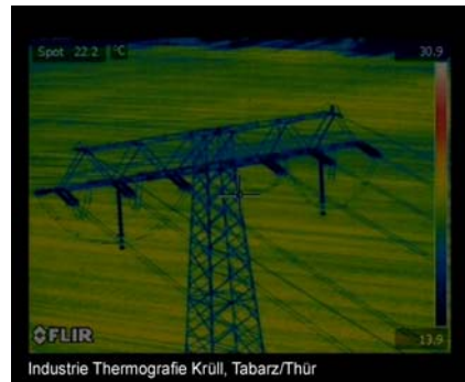
24 und 25 220kV Freileitungsmast im Sicht - und IR- Bild
