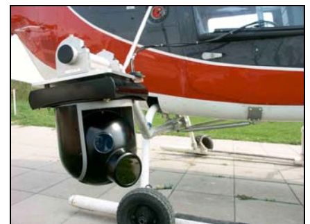
23 kreiselstabilisierte Plattform zur Aufnahme von IR- und Sichtkamera am Helikopter
